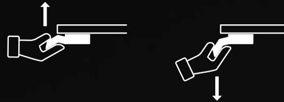
Pour éviter tout mouvement involontaire, le réglage en hauteur requiert une double action au niveau de l'élément de commande : il suffit de poser le doigt sur la touche puis d'incliner légèrement dans le sens de la direction souhaitée, le plateau montera ou descendra alors, tout simplement.
